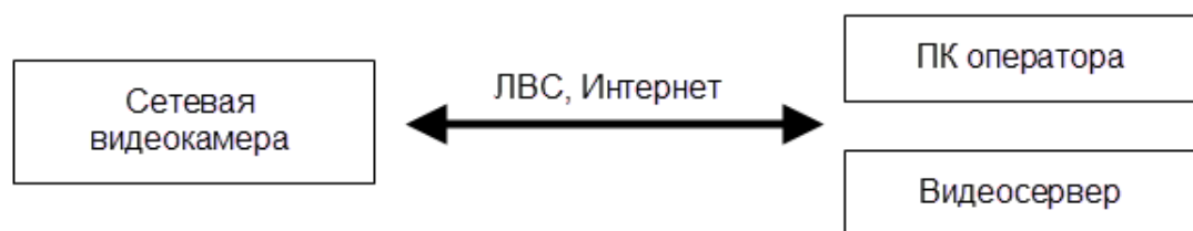
Рис. 1. Схема передачи данных потребителям от IP-видеокамеры
