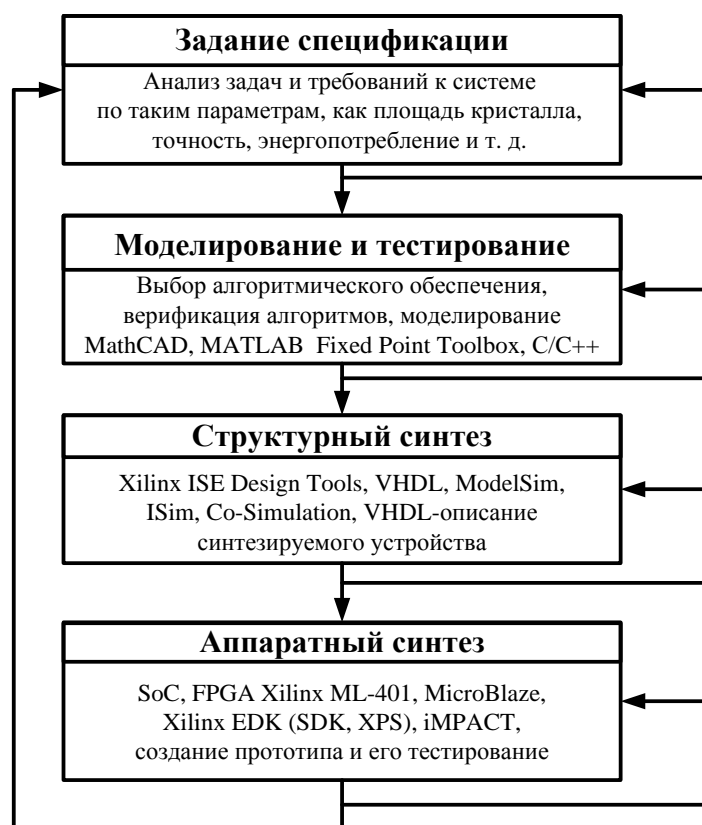
Рис. 3. Этапы быстрого прототипирования программируемых систем-на-кристалле ПЛИС
