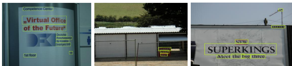
Рис. 5. Примеры локализации текста, выполненной с помощью предложенной модели нейросетевого детектора, на изображениях базы ICDAR 2013
