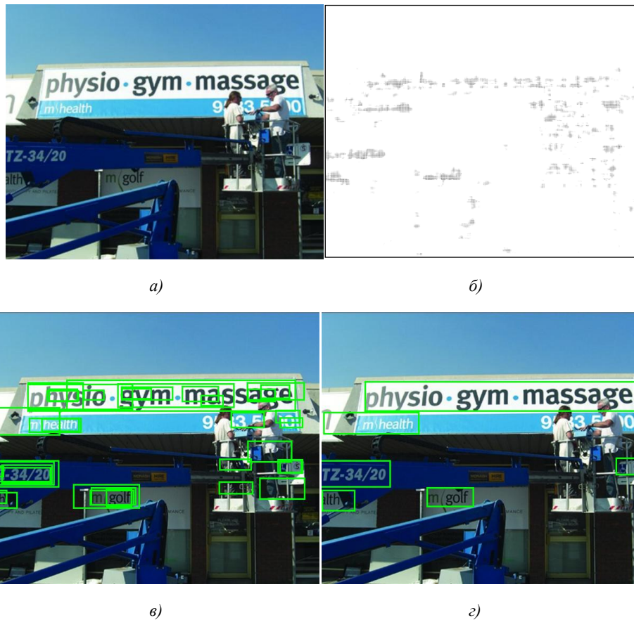
Рис. 4. Примеры изображений: а) сцены; б) матрицы уверенности детектора для изображения в одном масштабе; в) блоков различных масштабов изображения; г) итоговых текстовых блоков
