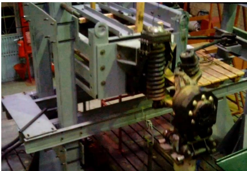
Рис. 3. Снимок стенда для испытания адаптивной подвески, нагруженной подпружиненной массой
