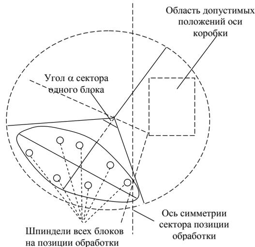
Рис. 8. Определение центра и радиуса поворотной шпиндельной коробки
