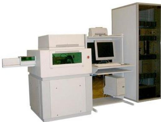
Рис. 2. Установка автоматического контроля топологии на фотоплашках ЭМ-6329
