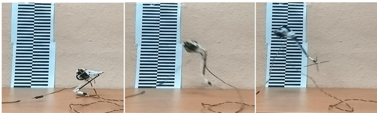
Рис. 2. Пример исследования прыжковой локомоции роботов
