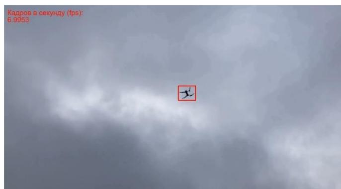
Рис. 5. Кадр, полученный камерой во время работы алгоритма отслеживания квадрокоптера
