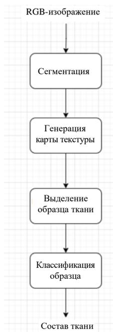
Рис. 1. Алгоритм определения состава ткани
