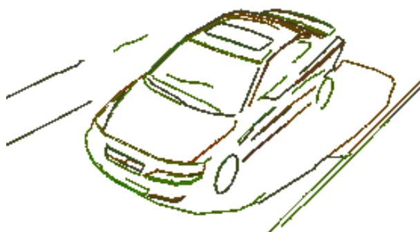
Рис. 4. Изображения автомобилей и векторные представления их контуров, полученные с помощью предложенного алгоритма
