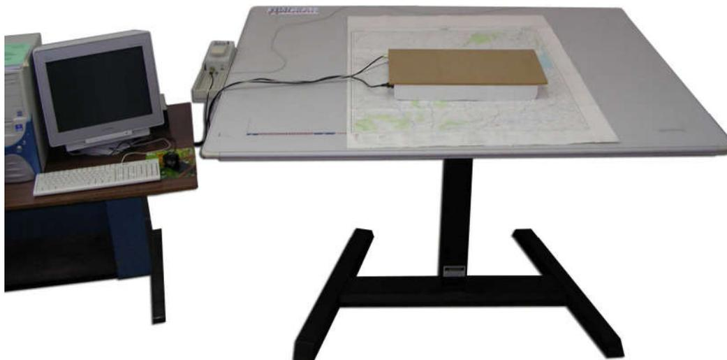
Рис. 5. АПК ДИСКАН на базе дигитайзера CalComp 34600 и малоформатного планшетного сканера ScanMaker X12USL фирмы Microtek
