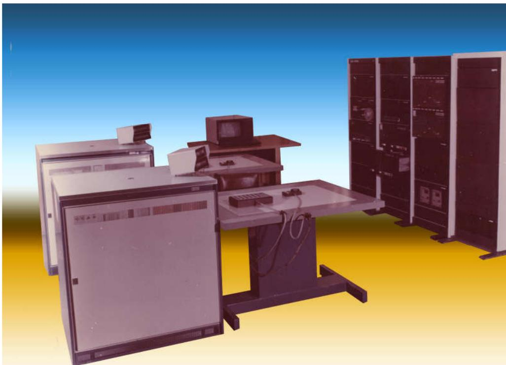
Рис. 2. Дигитайзеры ПЛАНШЕТ-Р производства Ульяновского ПО «Комета» в составе АРМ-К
