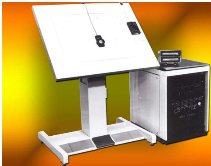
Рис. 1. Дигитайзер ПЛАНШЕТ-РА производства ЦКБ с ОП АН БССР
