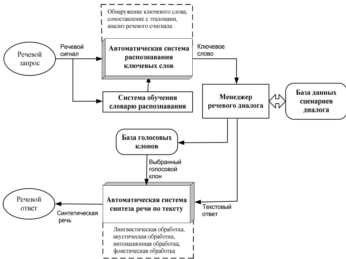
Рис. 8. Структурная схема системы РЕВИРС
