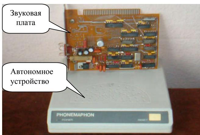
Рис. 6. Микроволновой синтезатор речи
