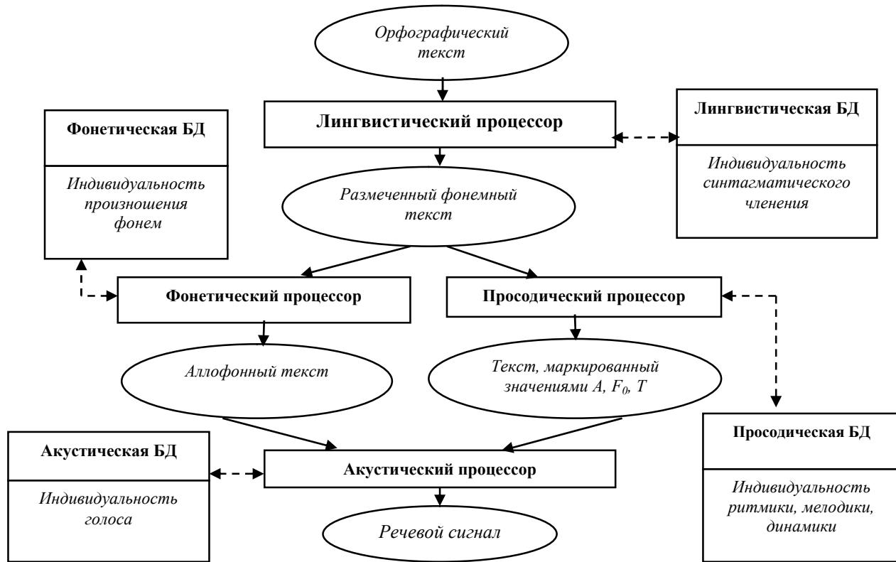
Рис. 7. Общая структурная схема аллофонно-волнового синтезатора речи по тексту
