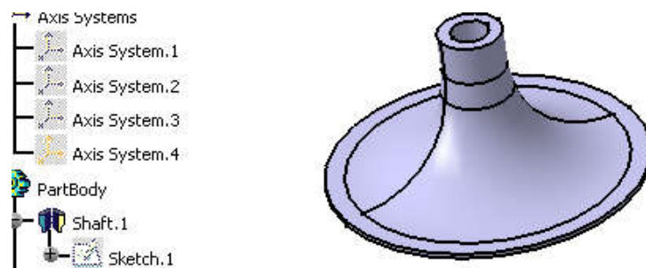
Рис. 2. Фрагмент дерева построения и модель основного тела колеса компрессора
