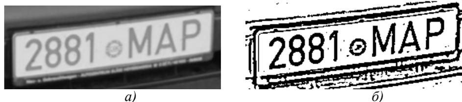
Рис. 4. Пример адаптивной пороговой бинаризации:
