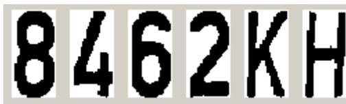
Рис. 8. Отмасштабированные символы НЗ, подготовленные для классификации
