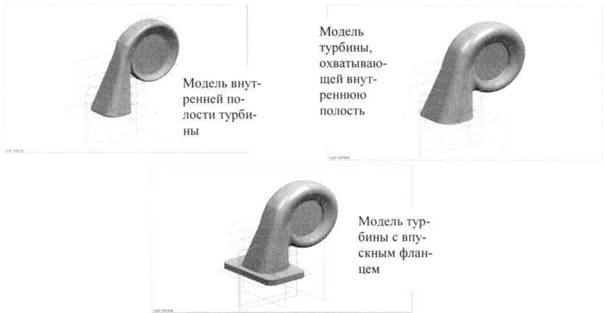
Рис. 2. Твёрдотельная модель воздуховода и часть корпуса турбины, охватывающая воздуховод
