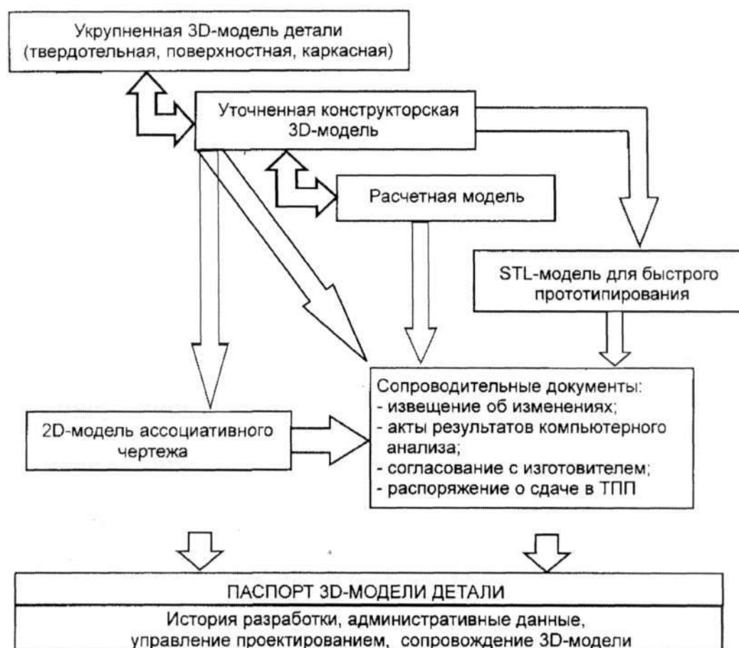
Рис. 2. Структура полной электронной модели полимерной детали
