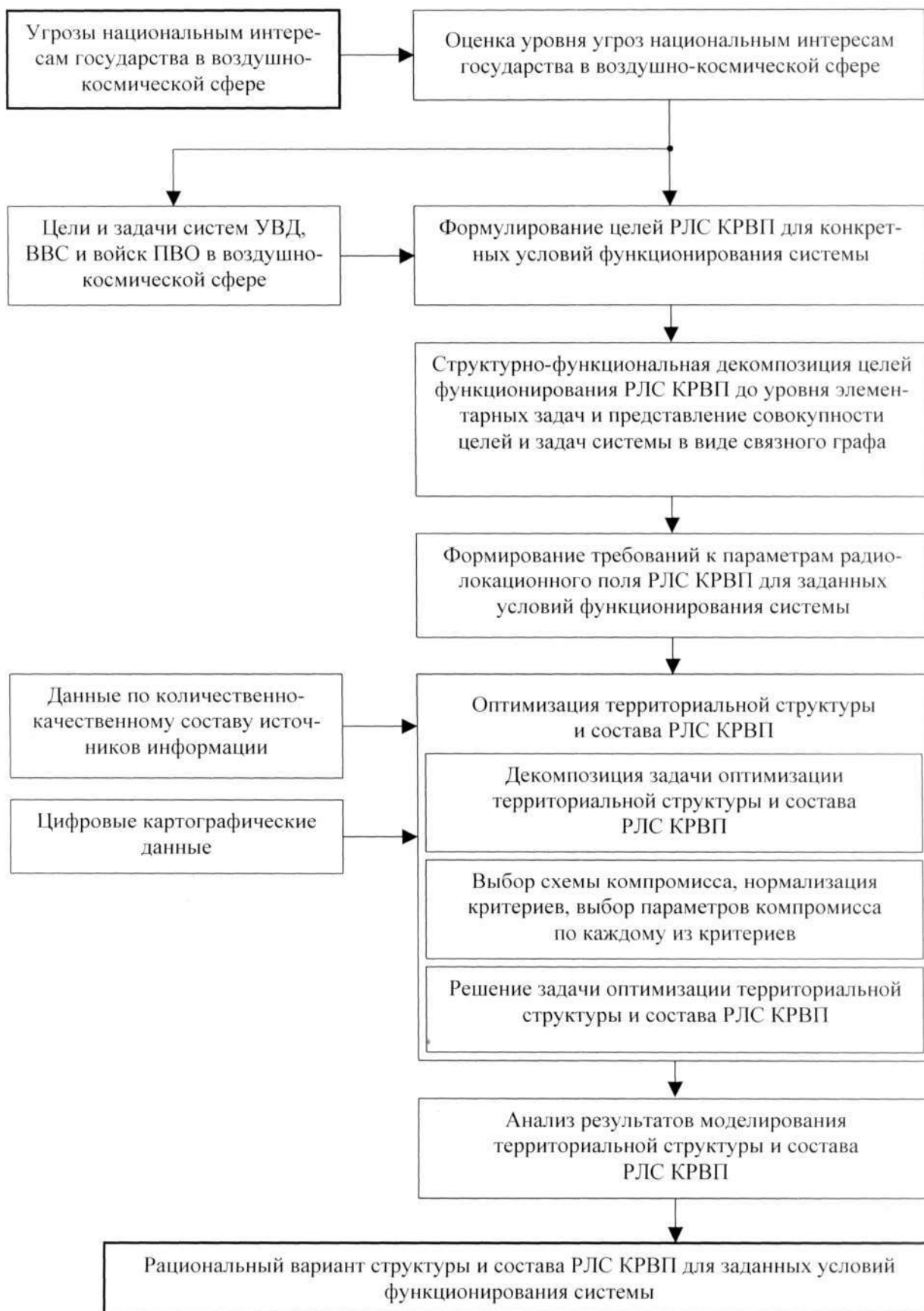
Рис. 1. Блок-схема алгоритма выработки решения по рациональному построению и реконфигурированию РЛС КРВП
