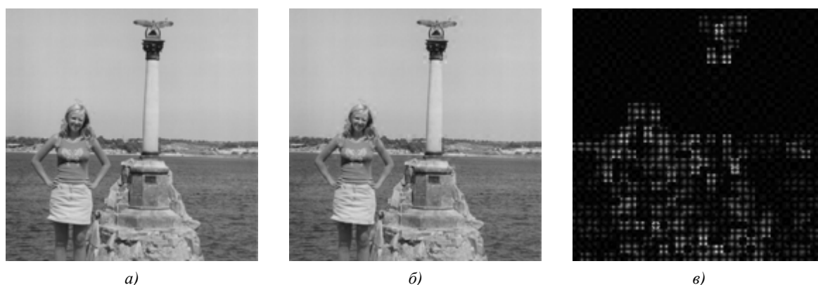
Рис. 4. Визуальная оценка значимости частот в изображении: а) исходное изображение; б) фильтрованное изображение; в) разностная картина, усиленная в десять раз
