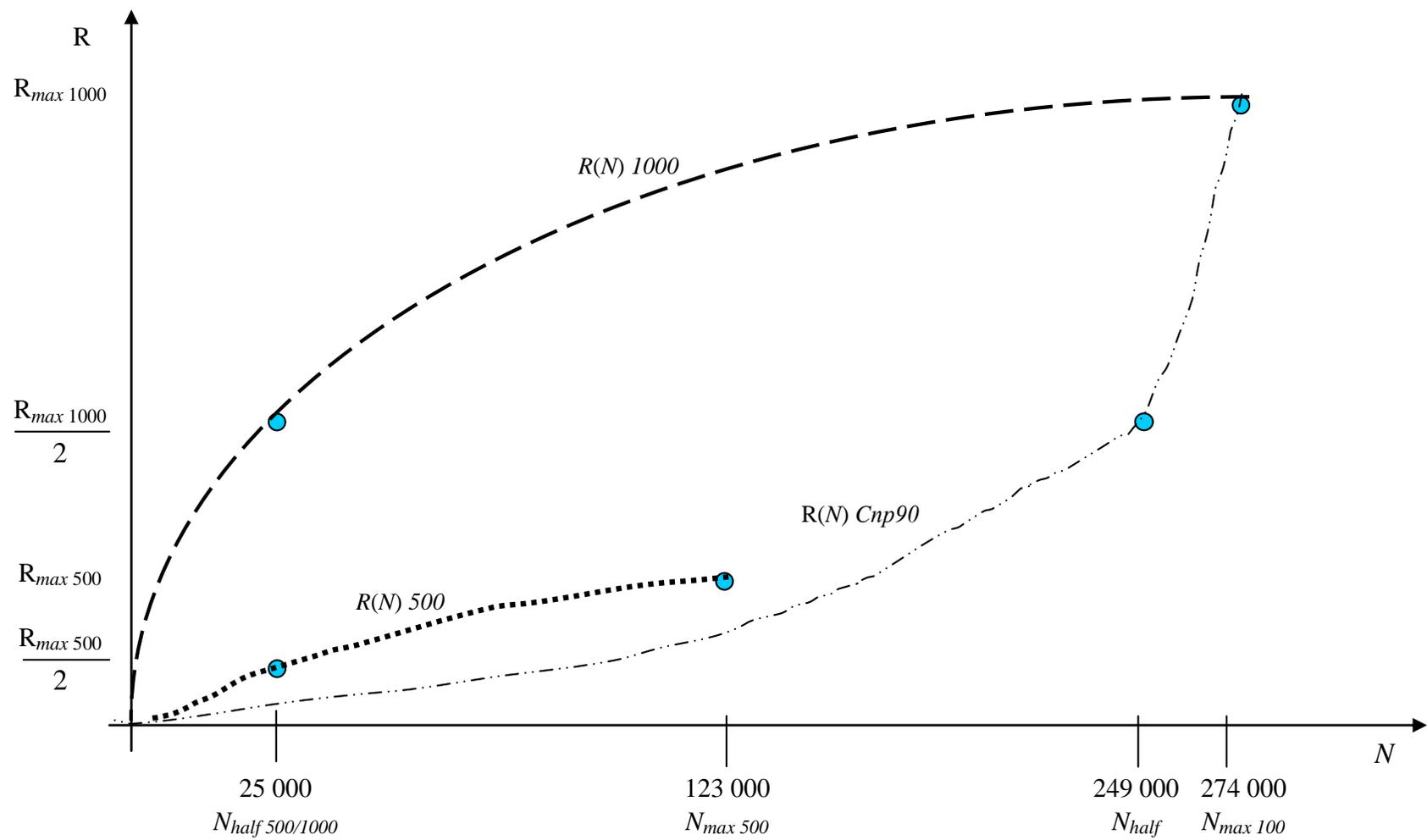
Рис. 2. График изменения производительности в зависимости от соотношения между  $N_{half}$  и  $N_{max}$  для SKИФ К-500 и SKИФ К-1000 на тестах Linpack
