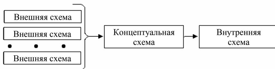
Рис. 1. Многоуровневая архитектура систем баз данных
