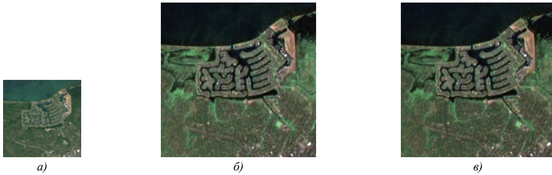
Рис. 3. Увеличение разрешения изображений алгоритмом 1: а) исходное цветное изображение, разрешение 30 м; б), в) цветные изображения, вычисленные алгоритмом 1 с разрешением 15 м по параметрам K_R=1 ; K_G=1 ; K_B=1 и K_R=0,299 ; K_G=0,587 ; K_B=0,114 соответственно
