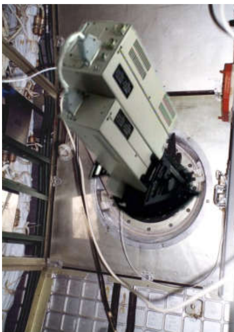
Рис. 7. Бортовая микропроцессорная видеофотометрическая система ВФС-3М, установленная на иллюминаторе служебного модуля МКС
