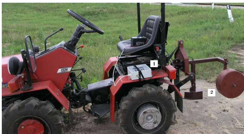
Рис. 6. Экспериментальный образец мобильного анализатора почвы, установленный на минитракторе: 1 – блок регистрации и координатной привязки; 2 – мультиспектральная система
