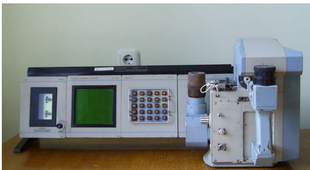
Рис. 1. Авиакосмическая спектрометрическая система «СКИФ»: слева – блок, осуществляющий накопление, отображение и обработку спектральной и служебной информации; справа – оптико-механический блок СКИФ-ОМ, включающий спектрометр, канал фотосопровождения, устройство визуального слежения за объектом
