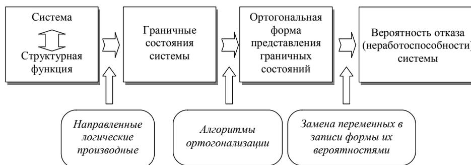
Рис. 4. Схема вычисления вероятности отказа системы
