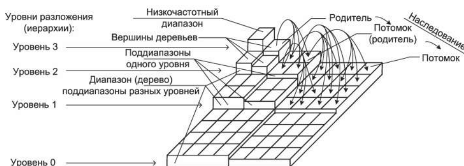
Рис. 1. Пирамида поддиапазонов и взаимосвязь «родитель – потомок» в одном из трех диапазонов (деревьев) 2D-вейвлет-разложения
