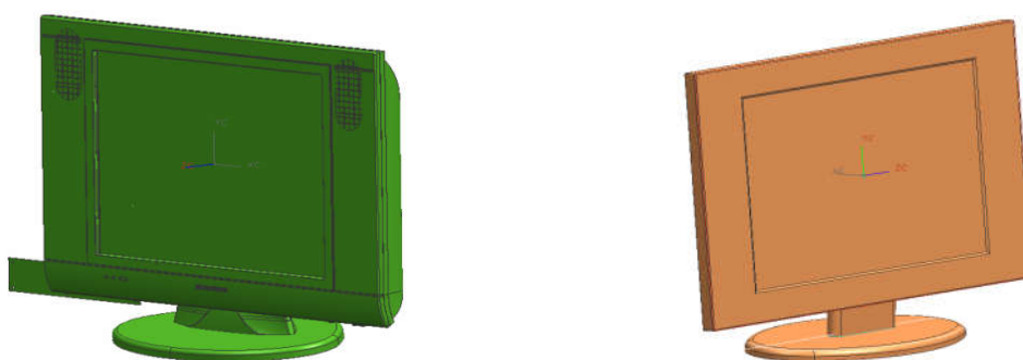
Рис. 2. Реальная и упрощенная 3D-модели телевизора
