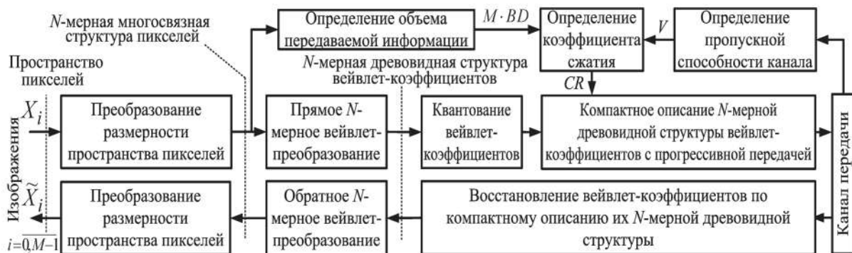
Рис. 1. Блок-схема метода прогрессивного вейвлет-сжатия полутоновых изображений
