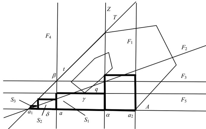
Рис. 4. Формирование прямоугольников для стороны  $a$ , когда угол между сторонами  $a$  и  $t$  является острым (вариант 2)
