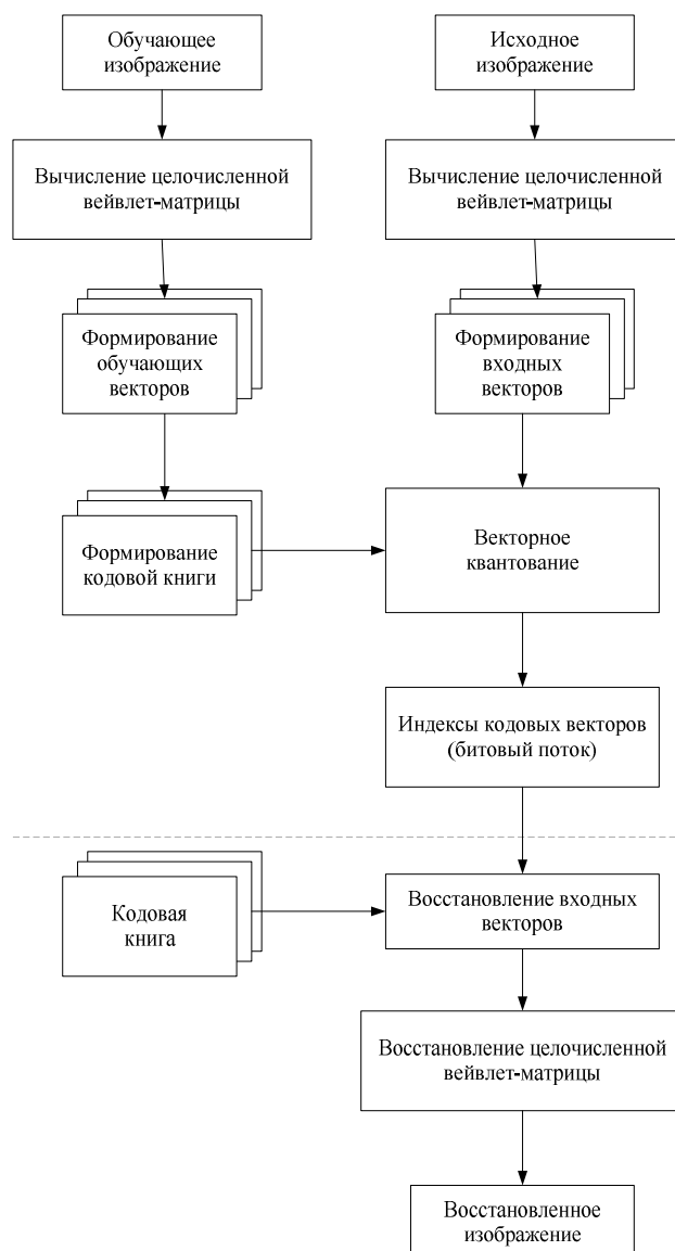
Рис. 1. Блок-схема субполосного прогрессивного метода векторного вейвлет-кодирования полутоновых изображений
