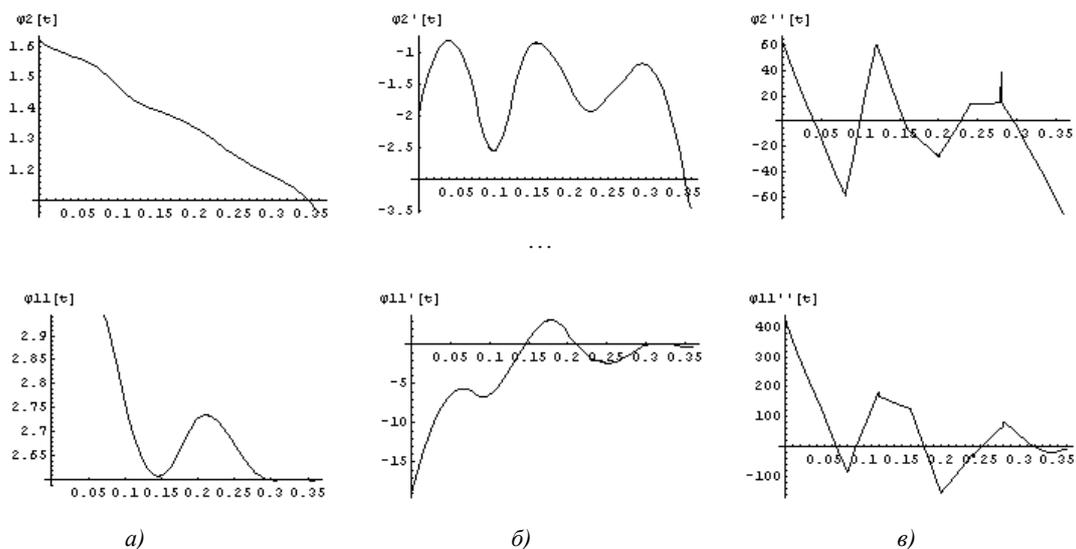
Рис. 2. Графики зависимостей для первого звена: а) угловой координаты; б) угловой скорости; в) углового ускорения
