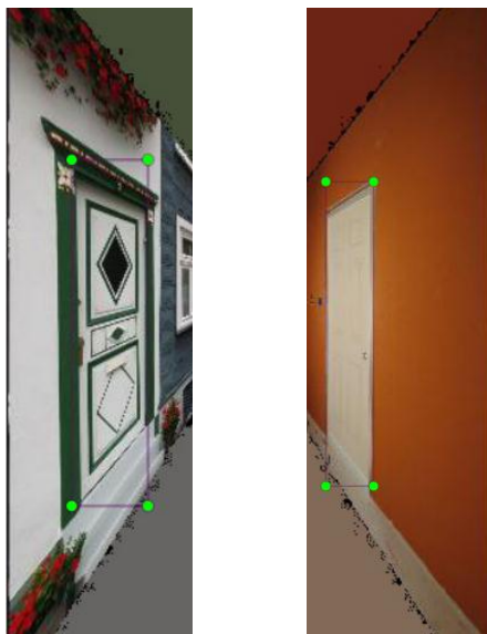
Рис. 2. Результат применения проективного преобразования для дверей, расположенных слева, и для дверей, расположенных справа
