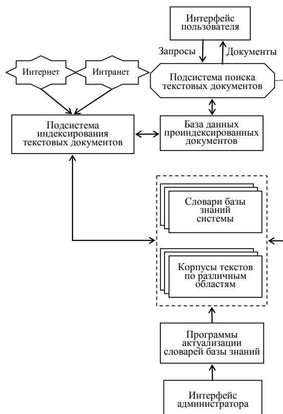
Рис. 1. Архитектура программного комплекса индексирования и поиска текстовых документов на основе динамических корпусов текстов
