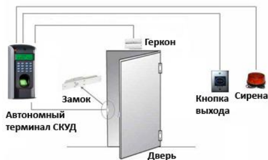
Рис. 11. Пример автономного биометрического терминала для контроля доступа в помещении
