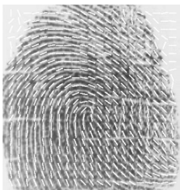
Рис. 6. Пример ориентационного поля: показано белыми стрелками для параметров w = 16 и w_\phi = 5
