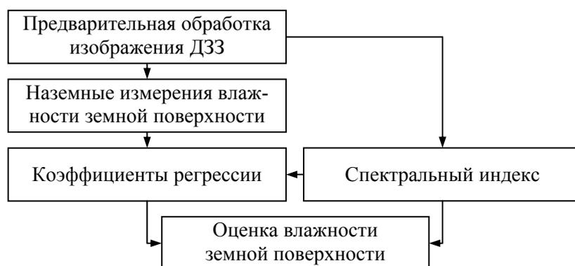
Рис. 2. Методика оценки влажности земной поверхности с использованием изображений ДЗЗ методом спектральных индексов
