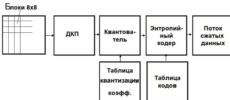
Рис. 6. Процесс ДКП изображения в формате JPEG
