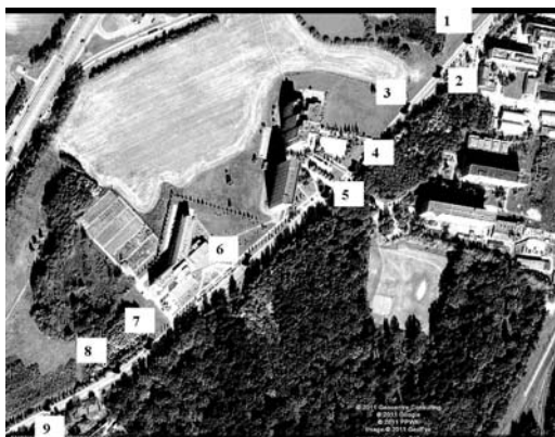
Рис. 3. Система расположения опорных точек, привязанная к местности
