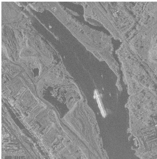
Рис. 3. Простое логарифмическое преобразование 30 \times \log(A_s + 1) создает слишком светлое изображение. Среднее значение яркости – 137,97, медианное – 138, std – 22,35
