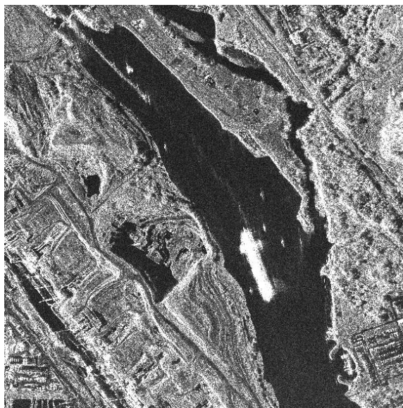
Рис. 2. Преобразование типа A_s(A_s > 255) = 255 . Потеряны детали в областях с большой яркостью
