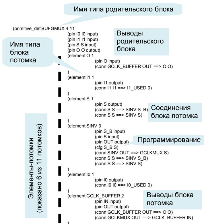
Рис. 1. Зависимость отношения обобщения для блока BUFGMUX из файла отчета
