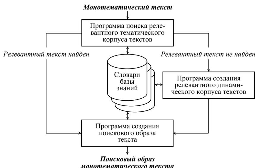
Рис. 2. Структурно-функциональная схема индексирования монотематического текста
