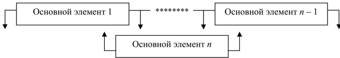
Рис. 5. ССД ЭС с дробным резервированием  $1/n$  (со скользящим резервом)
