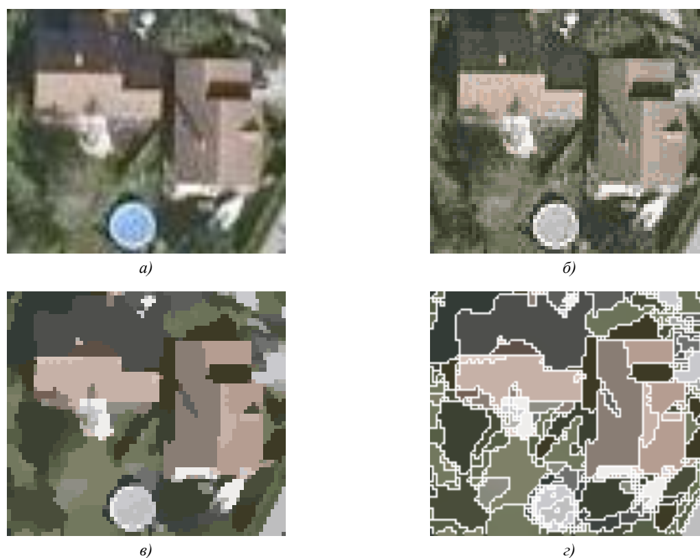
Рис. 3. Результат применения FCM и предложенного GPFCM к аэрофотоснимку: а) часть исходного аэрофотоснимка; б) результат применения к нему FCM; в) результат применения к исходному изображению а) GPFCM; г) результат применения к исходному изображению а) GPFCM вместе с границами кластеров
