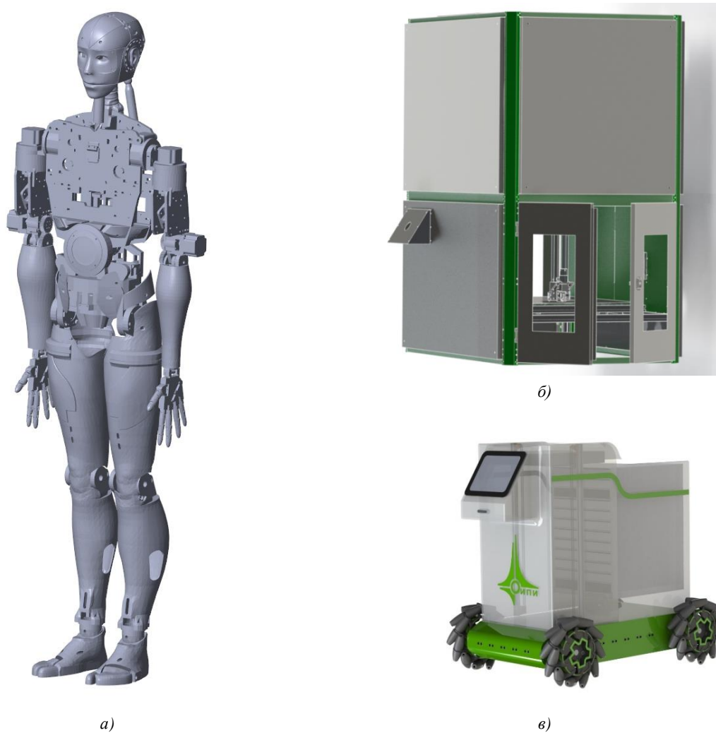
Рис. 8. Перспективные разработки: а) антропоморфный робот Newman (модель в среде Simulink); б) 3D-принтер промышленного класса в сборе; в) модульная транспортная платформа
