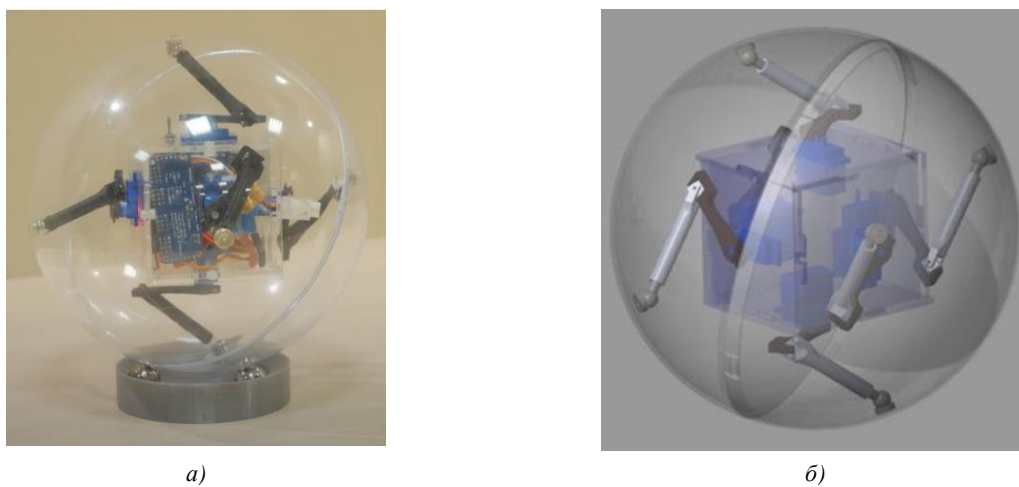
Рис. 3. Сферический мобильный робот: а) действующий прототип в акриловом корпусе; б) модель в среде Simulink
