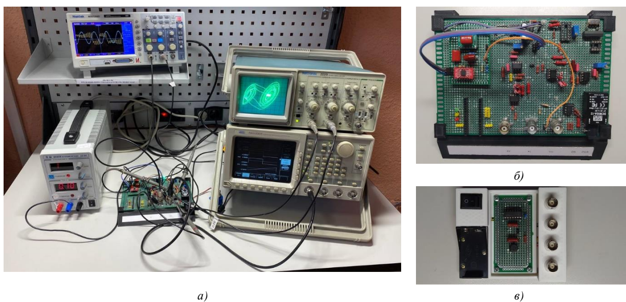
Рис. 7. Исследование нелинейных процессов в электронных схемах: а) экспериментальный стенд; б) электронный генератор хаотических колебаний с устройствами управления и обработки сигналов; в) схема Чуа
