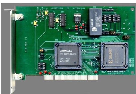
Рис. 2. Сетевой адаптер с аппаратным шифрованием для однородных и неоднородных локальных вычислительных сетей
