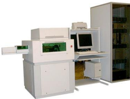
Рис. 2. Установка автоматического контроля топологии на фотощаблонах ЭМ-6329
