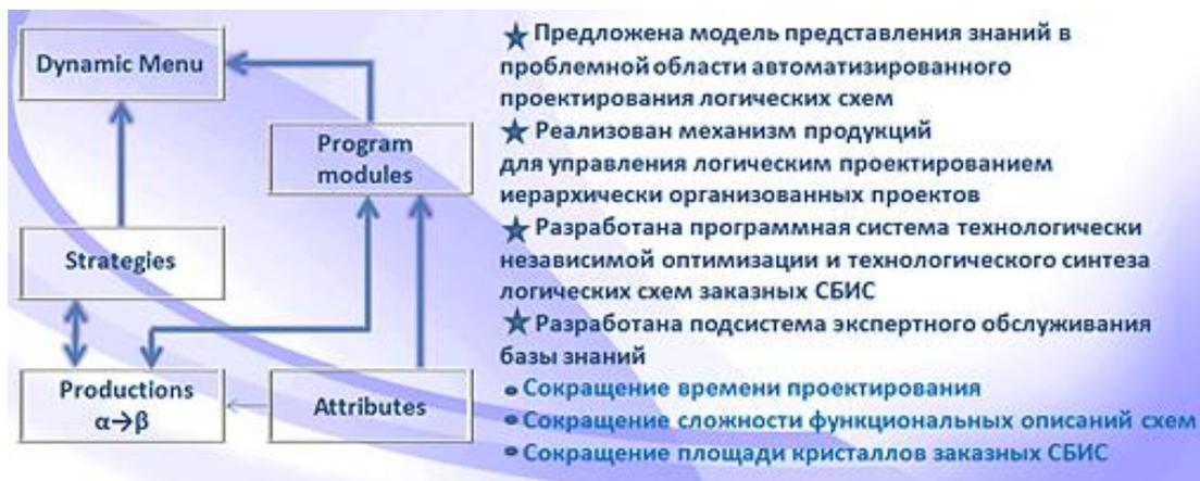
Рис. 6. Архитектура системы FLC-2
