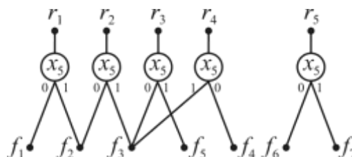
Рис. 2. Бинарная диаграмма решений – разложение по переменной x_5 Fig. 2. Binary Decision Diagram – decomposition by variable x_5
